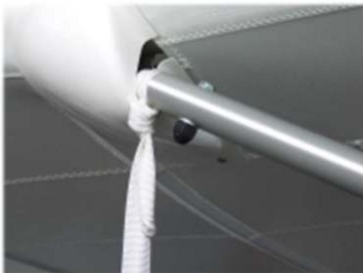
*Abbildung 4: oberer Befestigungspunkt an vorderer Flächenstrebe*
