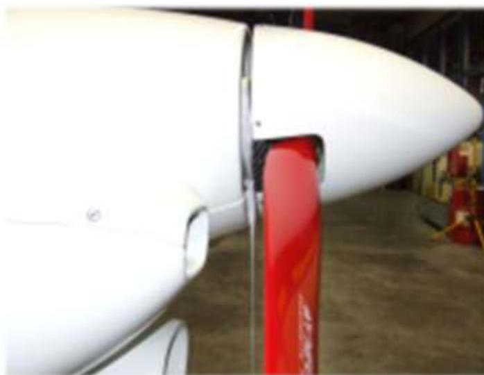
*Abbildung 5: Befestigungspunkt zwischen Cowling und Propellerspinner*
